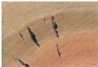
Figura 1 – Fendas internas na zona de transição entre o cerne e o borne. Híbrido TTGD
