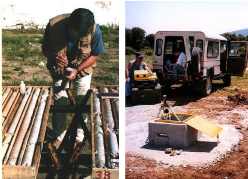
Figura 2 – Caracterização litológica e de fracturação nas carotes (à esquerda) e realização de diagrfias num piezómetro (à direita)
