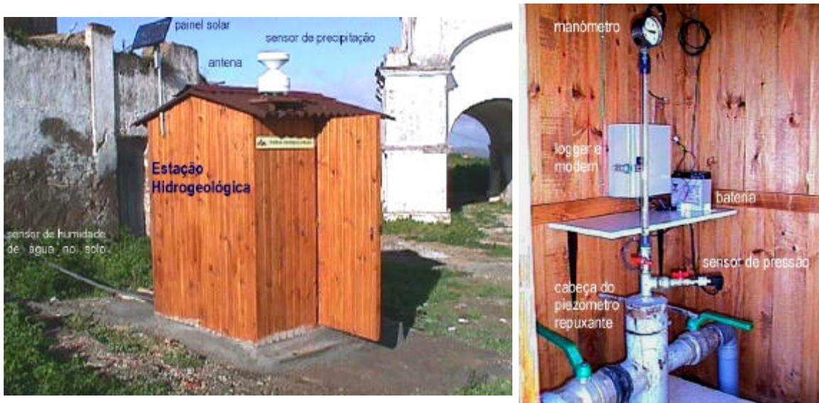
Figura 5 - Estação hidrogeológica do Castelo de Moura, vista exterior à esquerda e vista interior à direita
