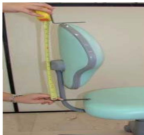
Figura 7. Medida do ajuste da altura do encosto.
