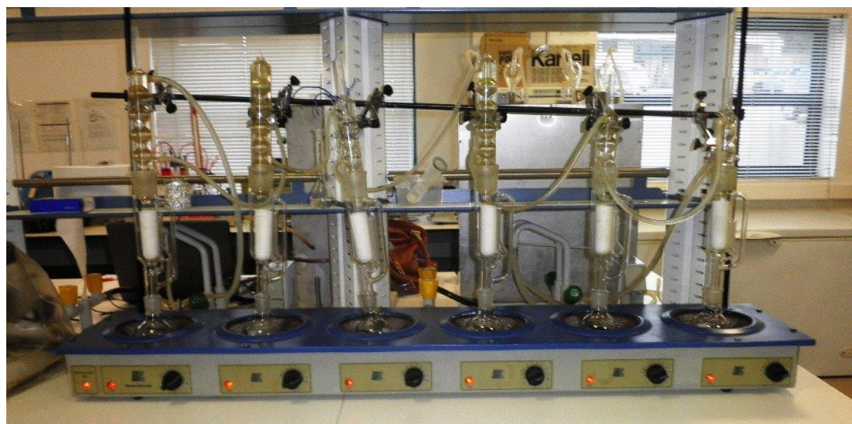
Figura 17- Aparelho de Soxhlet, em funcionamento.
