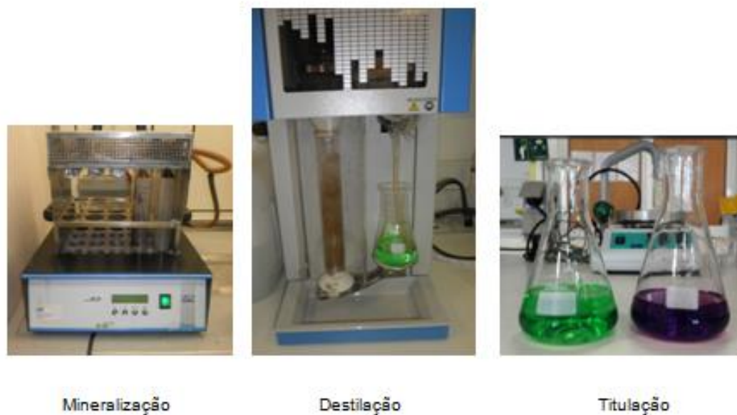
Figura 18- Esquema da determinação da proteína, mineralização, destilação e titulação, antes e depois da viragem de cor (verde para rosa)
