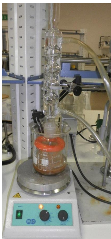
Figura 14- Condensador de refluxo e aquecimento em banho- maria usado na determinação da acidez.
