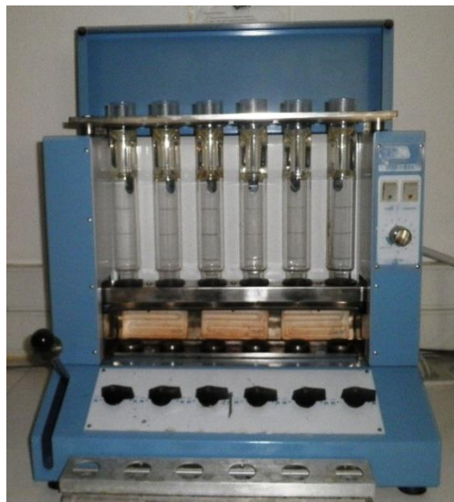
Figura 26-Aparelho utilizado na determinação da fibra bruta ("Dosi-fiber")
