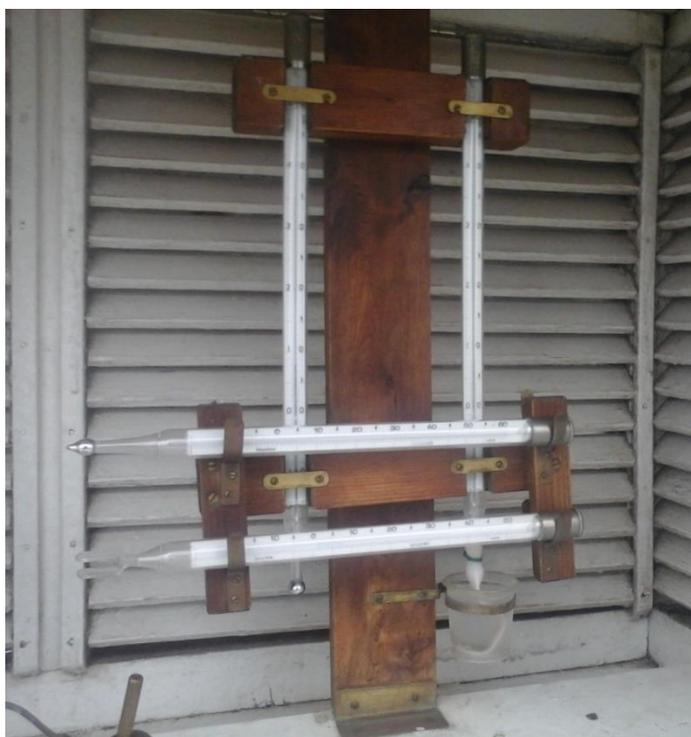
**Figura 17- termómetro de máxima e de mínima (fotografia da minha autoria retida na estação meteorológica de Viseu)**
