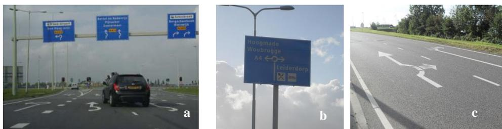
Fig.9. Turborotunda [24]: (a) sinais de afetação de vias; (b) painéis de pré-aviso; (c) setas de seleção
