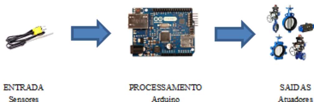
Figura 3-4: Esquema funcional do Arduino
