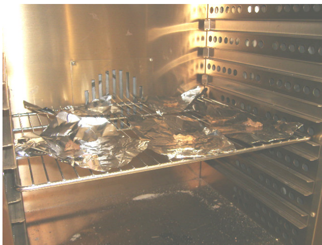
Figura 4 – Pedaços de pêras colocados na estufa, para cálculo da humidade.
