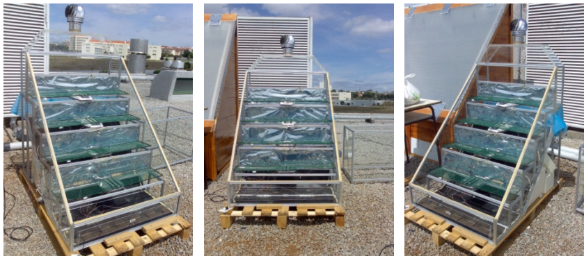
Figura 2 – Protótipo de uma nova estufa solar.
