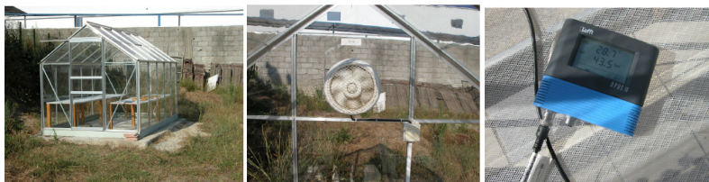
Figura 3 – Estufa solar localizada na ESAV (esquerda), extractor de ar (centro) e termohigrómetro (direita).
