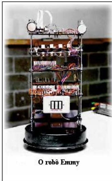
Figura 1 – Robô Móvel Autônomo Emmy – primeiro Robô com Controle Lógico Paraconsistente 1
