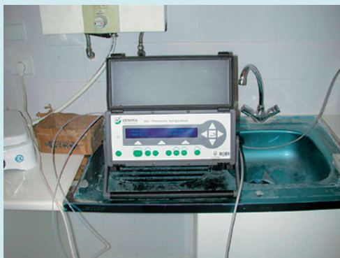
Equipamento dos gases traçadores (Determinação das renovações horárias)
