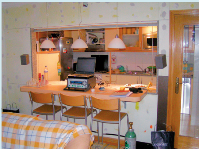
Ensaio de determinação das renovações horárias utilizando o equipamento dos gases traçadores
