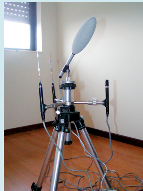
Equipamento para determinar as condições de conforto
