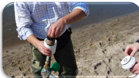
Figura 3.5 – Imagem que mostra o retirar do filtro do *housing* após a colheita efetuada.
