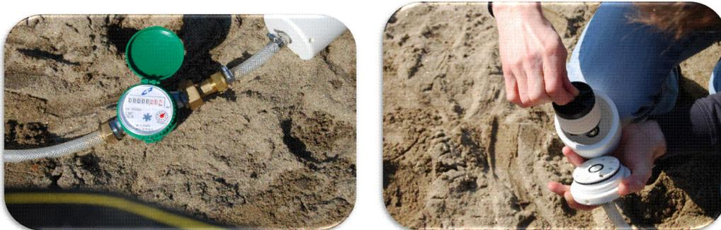
Figura 3.4 – Imagem do caudalímetro que mede o volume de água filtrado e da inserção do filtro no *housing*.
