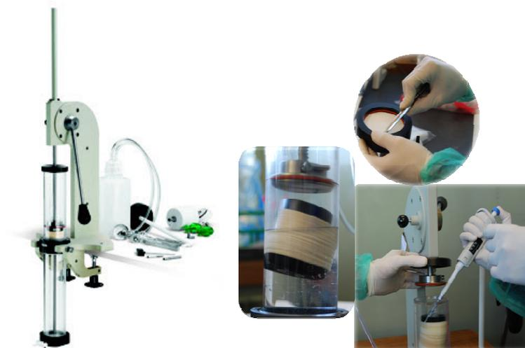
Figura 3.6 – Lavagem do filtro que contém a amostra no sistema Filtra-Max.
