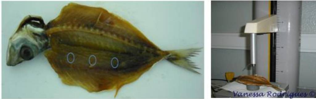
Figura 17 - Zonas de medição e ensaio de penetração.
