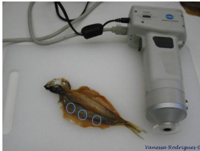
Figura 15 - Colorímetro Minolta CR 400 e zonas de medição na amostra a analisar.
