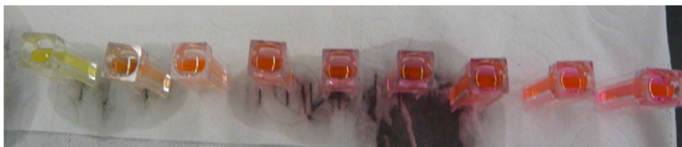
Figura 20 – Células para leitura em espectrofotómetro com o extracto butanólico. Observa-se uma cor que não é característica do aducto TBA-MDA.
