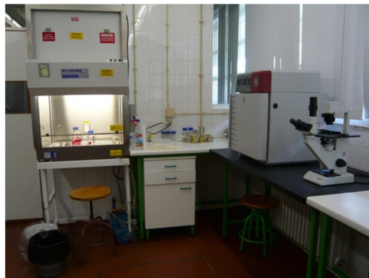
Figura 22 – Sala do laboratório de biociências onde decorreu o trabalho analítico. Visualiza-se a câmara de fluxo laminar com segurança biológica, classe II tipo A/B3, (Steril Gard-Baker Company) e a câmara de incubação (Shel Lab CO 2 Series).
