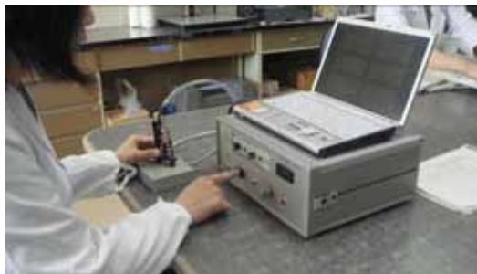
図5 石造文化財用打音試験装置
