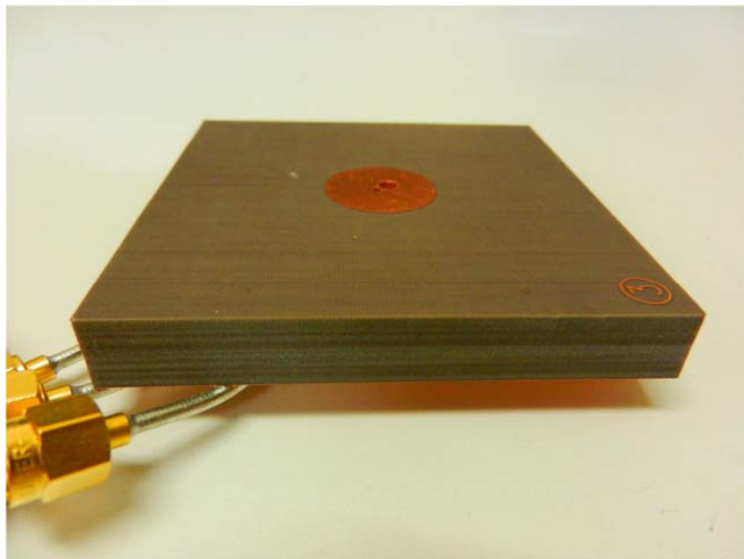
図 8.2 多層基板により試作したパッチ付き円板装荷モノポールアンテナ
