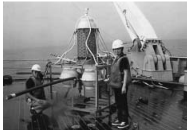
北西太平洋に敷設直前の「海底電磁気観測所」と準備に当たる富山大学院生
