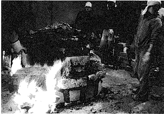
㉗—12月8日朝8時から薪に火を着け型焼きを開始する。まず焚き口で薪を燃やしオキを作る。
