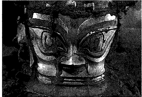
④—外范を落すと、数本の鑄バリが発生している。目や額の四角形には湯が薄く流れてかぶっている。これは炭火で爆ぜて原型を作り直したため、目、四角形も少し削って外范を合わせた事による。やむをえない結果と言える。この土を充分落とし、湯道、堰を切断する。砥石ではなく金ノコを使う。
