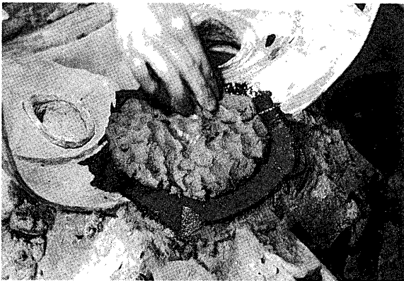
⑩—植物油を塗って、その墨汁を目安に50番真土で、スワセを范の中に埋め込みながら外范を作っていく。
