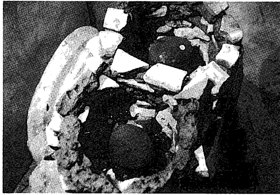
⑦一目の中子を肌焼きするため、素灰を目の周りに積んで行く。素灰の隙間から空気が入り炭がよく燃える構造にし、たっぷり炭を入れ素焼き色になるまでじっくり肌焼きする。
