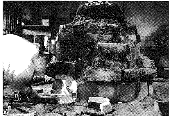
㉘—焚き口から薪を投入しレンガで蓋をする。窯の中が高温になると、下の空気穴を小さく絞る。天井穴にも素灰を沢山重ねて熱が逃げないように注意する。薪投入から1時間程で煙が出なくなり薪がオキになる。更に空気穴と天井穴を絞り熱を型の中心部へじっくりと追い込む。これ以上待っても型の温度が上がらないギリギリを見極めて次の薪を投入し燃えやすいように空気穴、天井穴を少し開く。これを繰り返して型を焼く。薪入れは全部で8回を要した。
