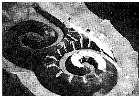
60—半面の中子削りが終わったら、また外型を被せ、ひっくり返して反対側の外型を開ける。写真のように、ハマりが凸になっている。反対側と同じように原型を削り、中子を作る。中子は巾置によって支えられ、浮いている状態があるので注意深く作業を進めなければならない。
