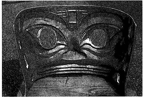
⑥—仮面本体の裏面には、あまり大きな鑄バリは発生していない。復元実験に取り組む前から、本体仮面の鑄造が最も大変な作業になると予想していたが、正にその通りであった。
