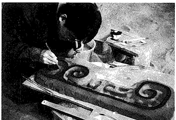
⑫一立て飾りの原型作り。半面ずつ作る。鑄物になる部分と中子を支える巾置の部分とが一体となっているので、鑄物になる部分に墨を塗り、確かめながら形を詰めていく。仕上げは水漉し真土を薄埴汁で溶いたものを塗り、さらに篋で形を整える。写真の原型に浮き出ている赤茶色の斑点は削り出された焼き真土の塊。
