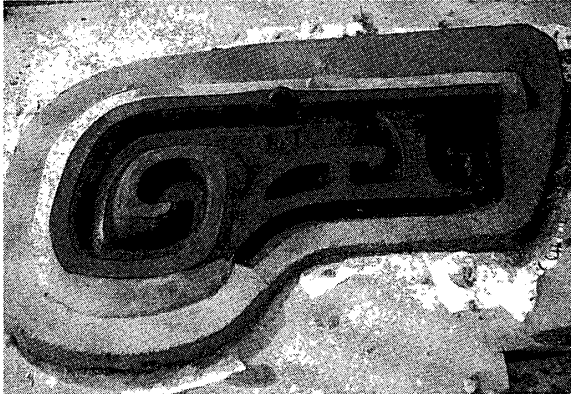
⑳—原型の周りに、外型の分割線に沿って巾置(特に外型同士が接するこの部分を「押さえ」という)を付け足す。立て飾り本体の横幅は4cmに設定しているので、この押さえ部分は定盤から2cmの高さの水平面となるわけである。この後、外型を被せ、反転して、この押さえを削り取ると、外型側の押さえから2cm立ち上がった、原型のシルエットを残した土が現れることになる。
