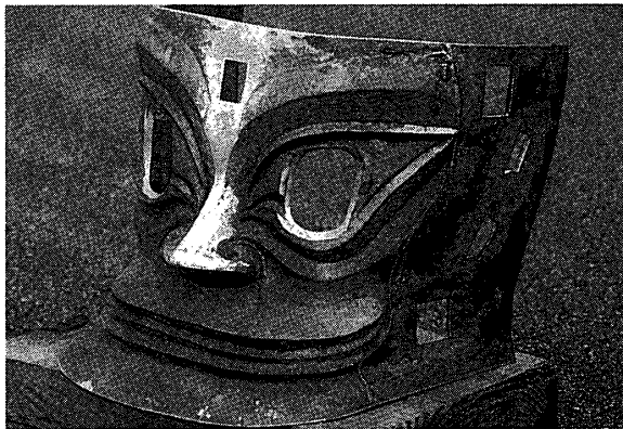
⑤—左目の上に小さな穴があいた。これは原型作り直しによるためである。額から鼻にかけてヤスリで研磨する。鉛が多く研磨しやすい。目や四角形の穴もヤスリで削って整える。特に耳の分鑄用の穴は、耳前面用、耳後面用にひとつの穴を分けて成形する。耳前面用は四角い穴の前半分なので分鑄後、後へずらないよう勾配をつける。
