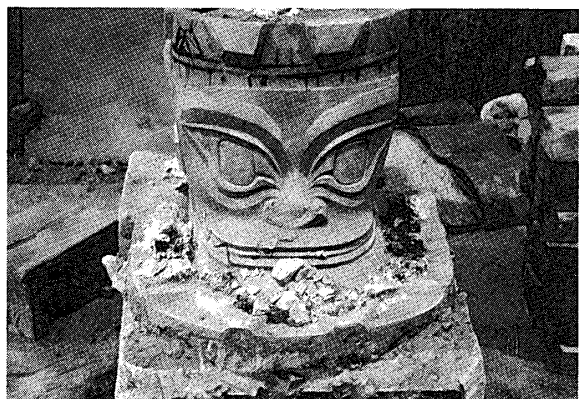
⑥—しかしながら実際の人頭像の中には、正面分割の痕跡が残るものがある。今回は、大きな外范の分割が実験目的の一つでもあり、正面を大きな一范とした。仮面下の水平な巾置には、外范が横に抜けるように窪みハマリを、額上の垂直巾置などには、注湯時の湯圧で外范が浮かされないようにでっぱりハマリを設けた。その後炭火で乾燥したが急加熱のため、鼻、口の一部が爆ぜて壊れた。
