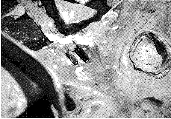
⑨—いよいよ最後の工程。一本になった立て飾りの突起部を仮面額の四角形穴に下から上向きに差し込み土間に土で固定する。炭火で強く全体を乾燥させる。
