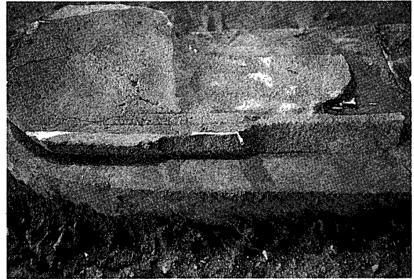
㉔—半面の外型が完成したところで原型ごとひっくり返し、まだ形の作られていない面を出す。外型の押さえ部分は立て飾りの縦割り真半分の位置になっているので、そこから立ち上がったところの上面がまだ作られていない半面の最上面となる。
