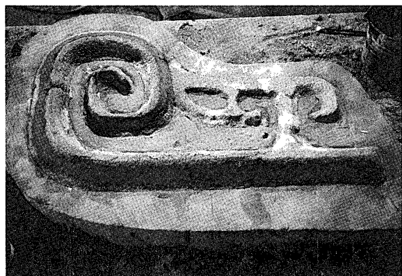
55—見切り線を頼りにもう半面の原型を作る。最初の半面は外型にくるまれているので、見るができない。記憶を頼りに形を詰めていく。
