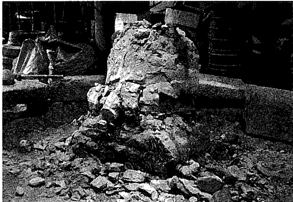
③—翌朝、ハンマーで叩いて外范を壊しながら青銅仮面を取り出す。全体がまだ熱く冷め切っていない。鉛が多い地金なので、叩いて折れる可能性は低いが、外范を叩く手加減を知るため、残った5mm厚の板状の地金をハンマーで実験的に叩いてみた。結果として、この成分の青銅は数回叩いても簡単には折れず、どんどん曲る事が解った。出土時の状態もバラバラに割れるというより曲っていたのではないかと想像した。
