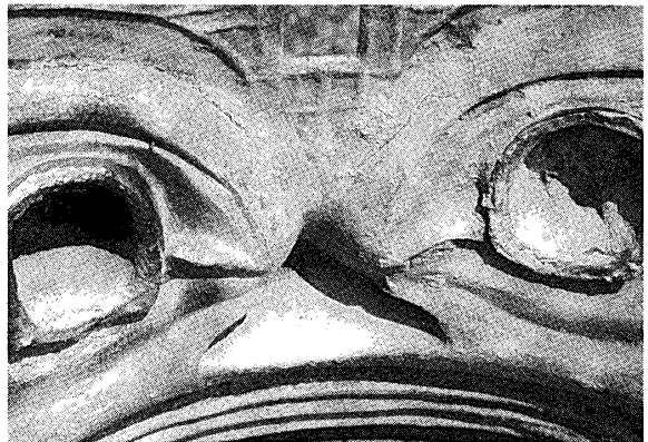
⑩一目に流した湯が仮面内側に入り込んで、固定された様子。三星堆縦目仮面と同じではないが、似たような痕跡となっている。目の注湯時、全体を炭火で加熱していたにもかかわらず、少し本体の目の付け根にキレツが入った。耳よりも多くの湯が内側に入り込むので、耳の後鑄より強く加熱しておく必要があるように思えた。
