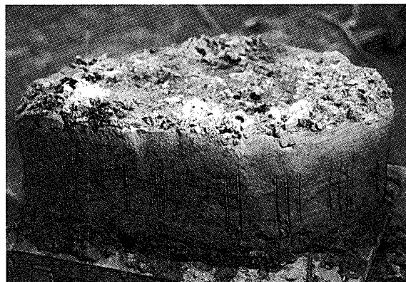
58—完成した外型。最初の半面同様の工程で、外型が完成する。側面の所々にある縦線は、型の開け閉めの際に目安となる合い印である。炭火でしっかり乾燥させる。
