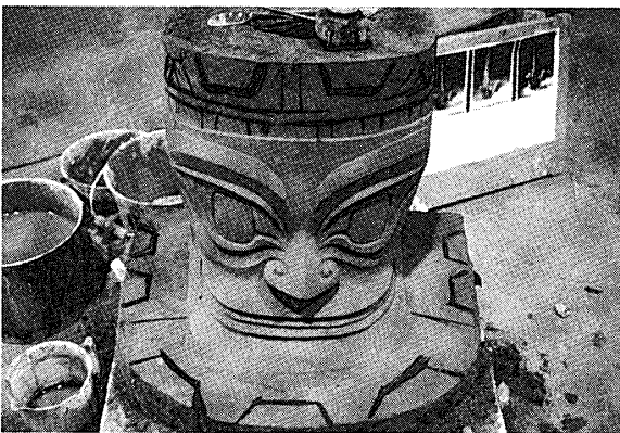
⑤—完成した原型。同時に巾置(范と中子、あるいは范と范で接しあう面)も完成させ、その巾置にハマリ(鑄型の横ズレを防ぐでっぱりと窪み)、湯道(溶けた金属が通って行く道)の位置を描く。更に外范の分割位置も描く。四川の研究者の一人は、中国では顔の正面で分割することを嫌うので三星堆青銅仮面、人頭像でもそれはないという考えを持っていた。その理由だけではないが、正面分割を避けた。
