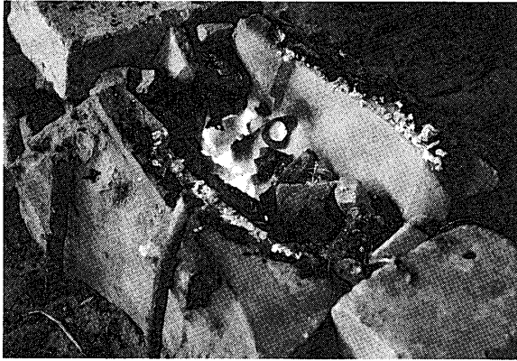
④—耳前面の外范と中子(内范)の型焼きは肌焼き法で行った。両方を向い合わせて立て、間に炭火を入れ、青銅が流れ込む鑄型面だけを焼く方法である。焼成の目安は塗った墨汁の黒色が素焼きの赤橙色に変化するまでである。これも真土の粘結に使った粘土の結晶水を除去するためで、充分でなければ、溶湯と結晶水が反応して多量のカスが発生し、鑄肌に窪みができたり穴があいたりする。
