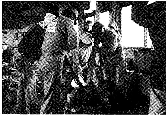
⑧外范を合わせ、土で隙間をふさぎ、棒を使って二人が外范を押さえつけ湯が漏らないようにして注湯する。この青銅も本体と同成分のものを使う。
