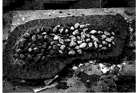
㉓—原型に離型剤(植物油)を塗り、外型の第一層を被せる。原型部分は100番篩、巾置部分は50番篩でカラ篩いした真土を埴汁で練ったものを使用した。その上に埴汁を塗り、焼き真土の塊を押し込んで、余分な水分を吸わせる。この工程は、型の強度を増し、乾燥の際の収縮を抑える。その上にさらに50番鑄物土を埴汁を付けながら被せ、これを繰り返して鑄型に必要な厚みを得る。
