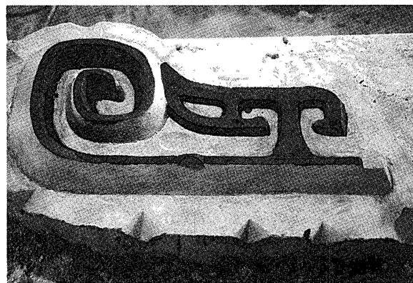
57—完成した残り半面の原型。これで原型の両面全てが完成となる。墨が塗られたところが金属になるところで、後にこの部分は金属の厚み分削られて、原型は中子となる。押さえの水平面以外の土色の部分が巾置で、常に外型と接し、中子を支える役目を果たす。外型の押さえの際の三角形の凹みは「ハマリ」といって外型同士が横ずれしないようにするためのものである。
