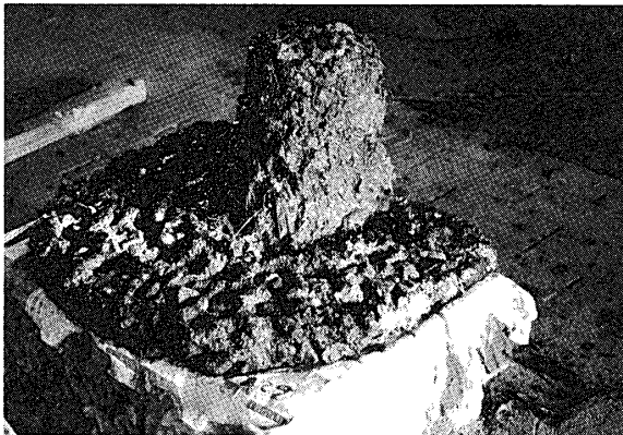
③—中心部には10番篩通しの粗い真土(焼いた砂)に大量の藁ツタ、モミ殻を加え粘土汁で練った砂を使う。乾燥、焼成による収縮、膨張で発生するキレツを防ぐ目的で藁、モミを多めに加えた。芯のレンガから約10cmの厚さに付け、その後は藁ツタ、モミ殻を少なくした砂で形を作って行く。一度炭火で全体を乾燥させる。
