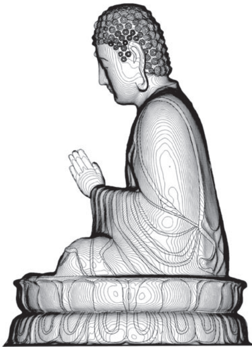
<図2>天王寺大仏レーザー測量図(作図:アコード) 後世の補修部分も含めてレーザー測量し図化している
