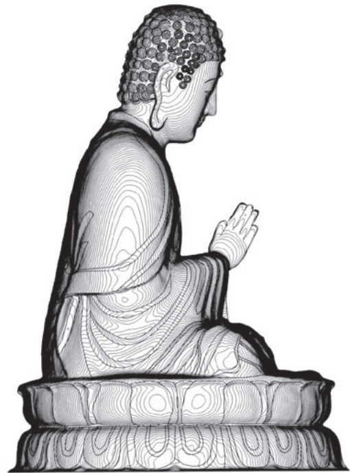
<図2>天王寺大仏レーザー測量図(作図:アコード) 後世の補修部分も含めてレーザー測量し図化している
