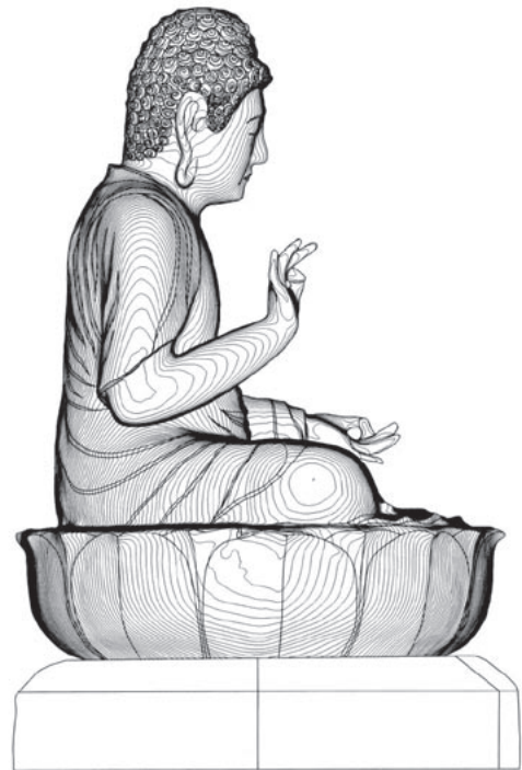
＜図1＞九品寺大仏レーザー測量図（作図：アコード） 六角形の石製の蓮台の上に、青銅製の蓮台が置かれ、その上に大仏が置かれている
