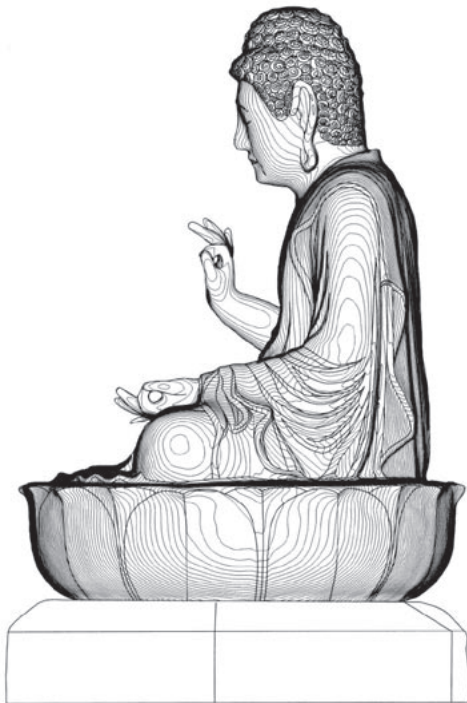
＜図1＞九品寺大仏レーザー測量図（作図：アコード） 六角形の石製の蓮台の上に、青銅製の蓮台が置かれ、その上に大仏が置かれている
