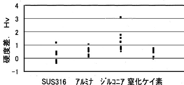
図14 摺動面の硬度変化
