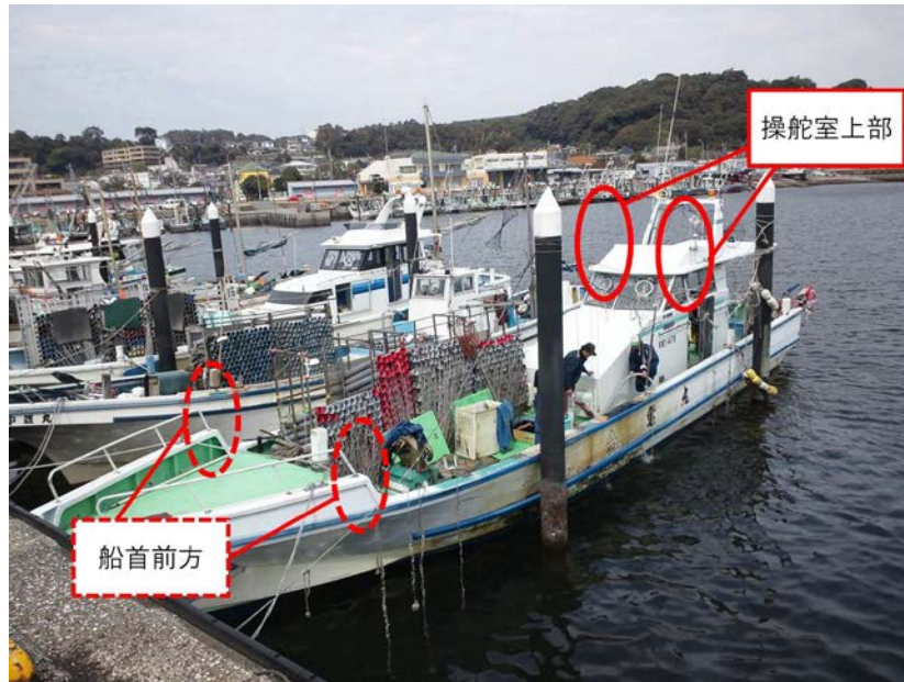
図 5.5.2 回転灯の設置場所
