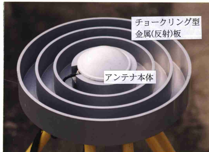
写真4: グランド・プレーンを装備したGPSアンテナ
