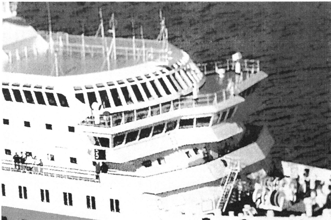
図3 近代化操船装置を搭載する大型客船の前方突出船橋
