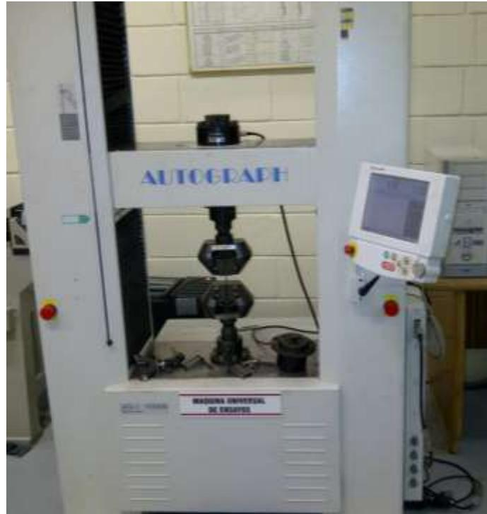
*Fig. 3.10 Máquina universal de ensayos Shimadzu AG-I*
