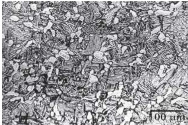
*Fig. 2.4 Microestructura Duplex del Ti-6Al-4V [9].*
