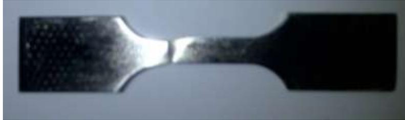
*Fig. 4.28 Fractura de una probeta de Ti c.p. en estado de suministro.*
