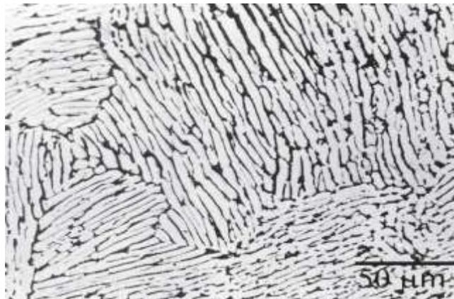
*Fig. 2.6 Microestructura Widmanstätten del Ti-6Al-4V. [9]*
