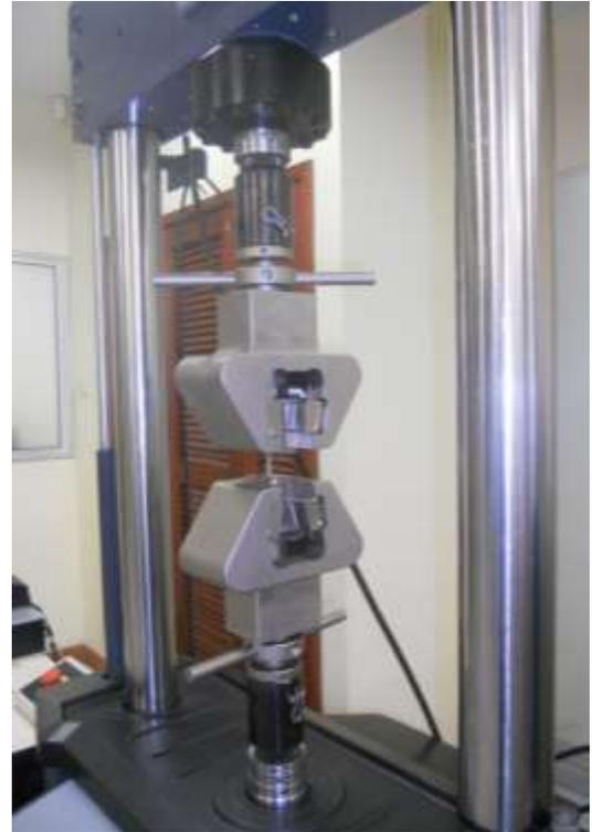
*Fig. 3.11 Máquina de fatiga MTS Landmark.*
