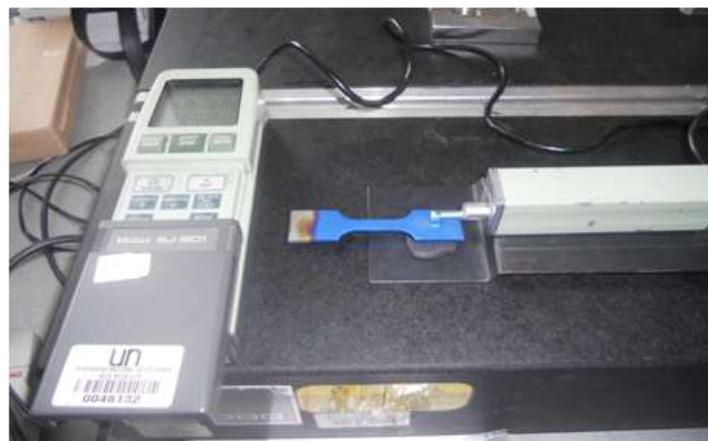
*Fig. 3.9 Montaje medición de rugosidad con Rugosímetro Mitutoyo SJ-201P*
