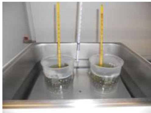
*Fig.3.5 Probetas de *Ti c.p.* y *Ti-6Al-4V* sumergidas en concentración de *HF**
