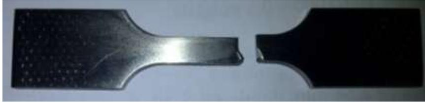
*Fig. 4.34 Fractura de una probeta de Ti-6Al-4V en estado de suministro.*
