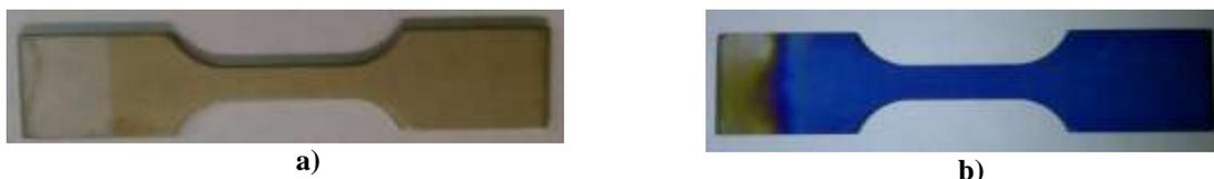
*Fig. 4.2* Aspecto macroscópico de probetas de Ti6-Al-4V. atacadas químicamente con HF y anodizadas a) 4V X 2min, b) 18V X 15min
