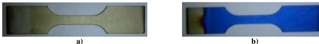
*Fig. 4.1* Aspecto macroscópico de probetas de Ti c.p. grado 2 atacadas químicamente con HF y anodizadas. a) 4V X 2min, b) 18V X 15min
