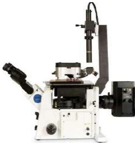
Fig. 4.39 Microscopio de Fuerza atómica con modo de indentación.
