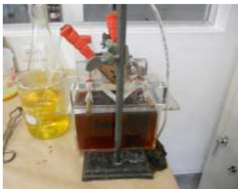
***Fig. 3.6 Montaje experimental para el tratamiento superficial de anodizado***
