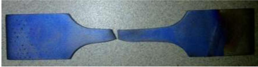
*Fig. 4.32 Fractura de una probeta de Ti c.p. +HF y anodizada a 18V X 15 min.*
