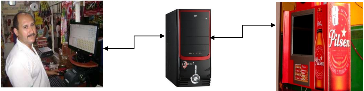
Figura 20. Configuración de los dos terminales utilizando una sola CPU
