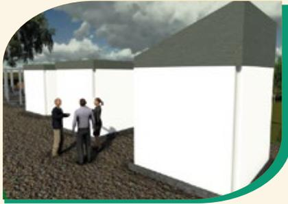
Las propiedades térmicas de los materiales de construcción se medirán, en condiciones reales, mediante módulos o espacios de modelación.
