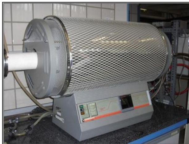
Figura 3-58. Horno de Sinterización CARBOLYTE STF 15/75/450 empleado para la sinterización de los compactos porosos.
