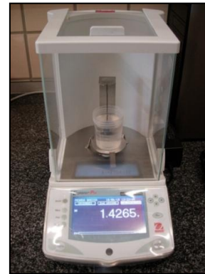
Figura 3-19. Balanza OHAUS EXPLORER PRO, medición de la masa sumergida.
