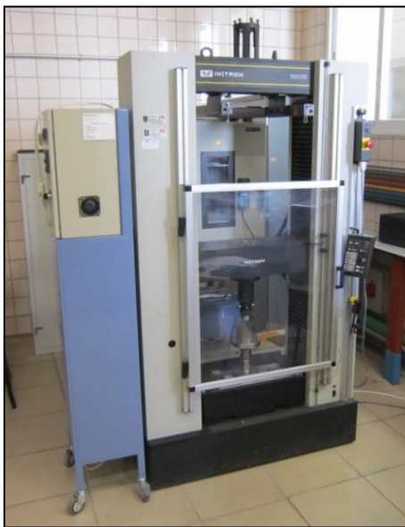
Figura 3-12. INSTRON 5505, equipamiento empleado para compactar los polvos de Titanio c.p.
