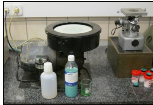
Figura 3-24. Pulido mecánico con pasta de diamante 3 mm en pulidora automática
