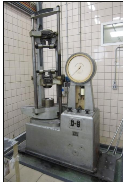
Figura 3-52. MALICET ET BLIN U-30, máquina utilizada para extraer los compactos en verde.
