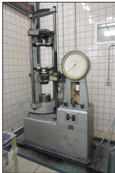
Figura 3-13. MALICET ET BLIN U-30, máquina utilizada para extraer los compactos en verde.
