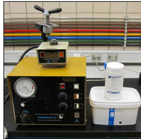
Figura 3-22. Empastilladora BUEHLER/METASERV PNEUMET.
