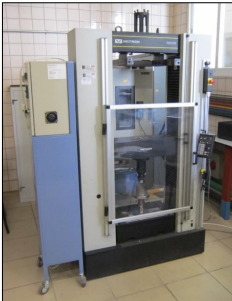
Figura 3-40. INSTRON 5505, equipamiento empleado para compactar los polvos de Titanio c.p.
