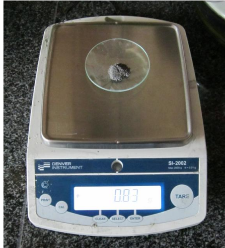
Figura 3-38. Balanza digital DENVER INSTRUMENT SI-2002 con precisión 0.01g.
