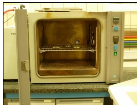
Figura 3-54. Estufa CARBOLITE empleada para el secado de las muestras después de los ciclos de eliminación del espaciador.
