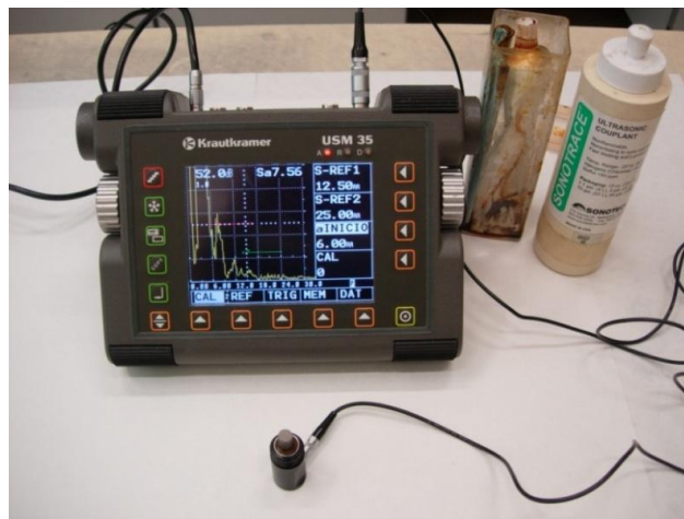
Figura 3-34. Equipo de ultrasonidos KRAUTKRAMER USM 35.
