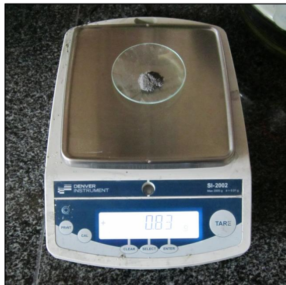
Figura 3-50. Balanza digital DENVER INSTRUMENT SI-2002 empleada para medir la masa del polvo de Titanio. El polvo se deposita sobre un vidrio reloj y se protege para evitar su rehidratación.
