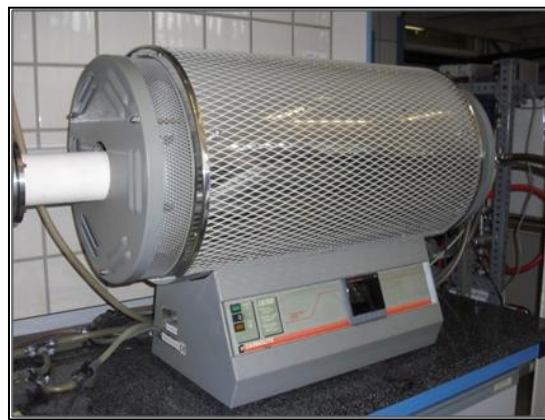
Figura 3-43. Horno de Sinterización CARBOLYTE STF 15/75/450.
