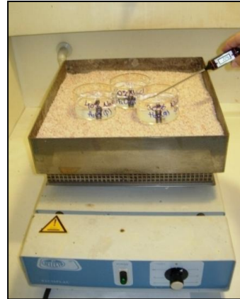
Figura 3-57. Baño de arena Recisplac P-SELECTA empleado para mantener la temperatura del agua destilada.
