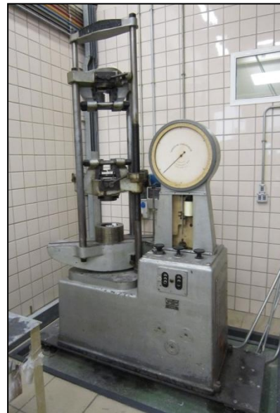
Figura 3-41. MALICET ET BLIN U-30, máquina utilizada para extraer los compactos en verde.
