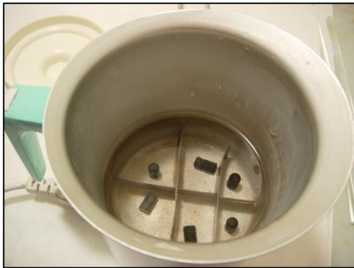
Figura 3-18. Detalle de las probetas dentro del calentador de agua.
