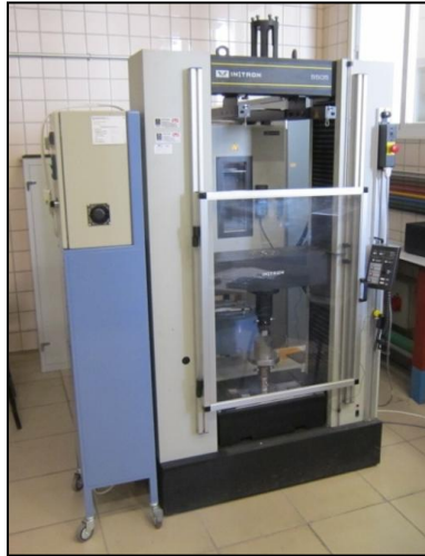
Figura 3-32. Instron 5505, equipamiento empleado para realizar los ensayos de compresión uniaxial.
