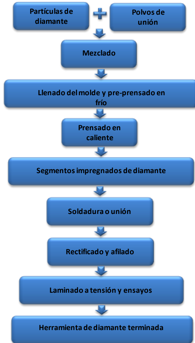
Figura 1-7. Proceso de obtención de herramientas de diamante mediante pulvimetalurgia [9]
