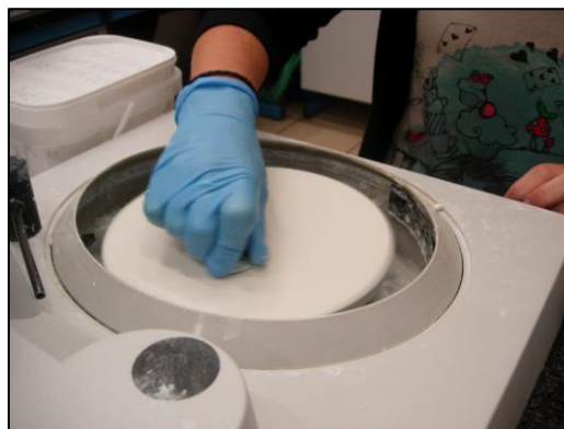
Figura 3-25. Pulido mecano-químico en pulidora orbital automática STRUERS LABOPOL-6.
