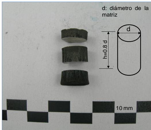
Figura 3-16. Compacto seccionado para estudiar posibles cambios de porosidad en la muestra.
