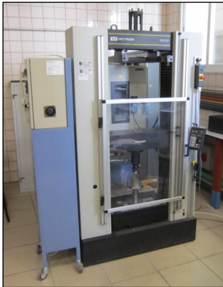
Figura 3-51. INSTRON 5505, equipamiento empleado para compactar los polvos de Titanio c.p.
