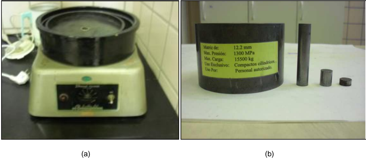
Figura 3-39. (a) Vibradora VIBROMET POLISHER usada para el vibrado de los polvos de Titanio; (b) Matriz y juego de punzones.
