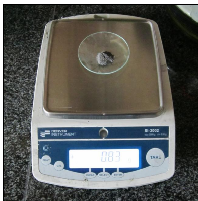
Figura 3-11. Balanza digital DENVER INSTRUMENT SI-2002 empleada para medir la masa del polvo de Titanio. El polvo se deposita sobre un vidrio reloj y se protege para evitar su rehidratación.
