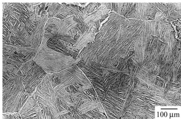
Figura 2-17. Ti-6Al-4V, \beta tratado térmicamente a 1020°C/20min/FC. La microscopía óptica muestra una estructura Widmanstätten \alpha con fase \alpha presente dentro de las fronteras de grano \beta [50].
