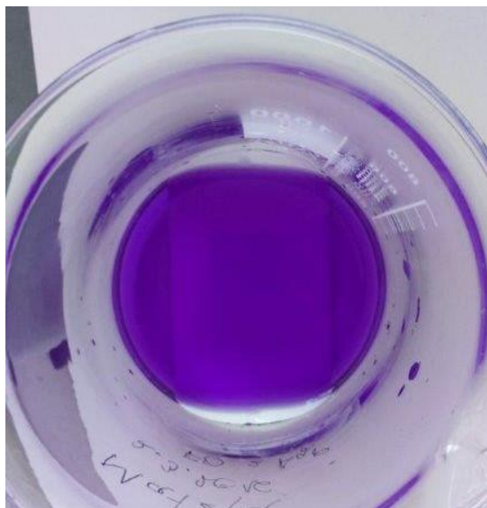
Slika 4-18: Namakanje membrane v raztopini metil vijolično
