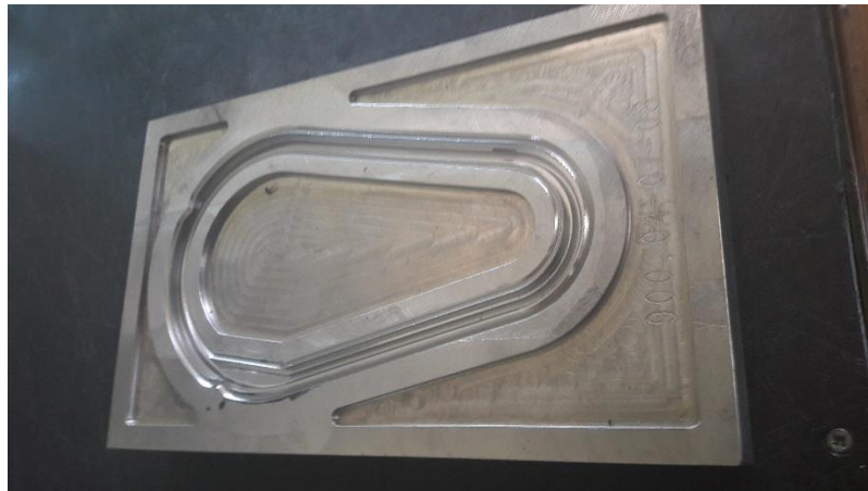
Slika 6.2: Orodje za tesnilo naprave za merjenje tesnosti ulitkov
