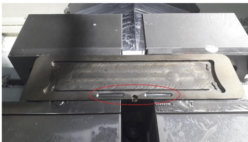
Slika 4.3: Rezkanje dodatnega volumna
