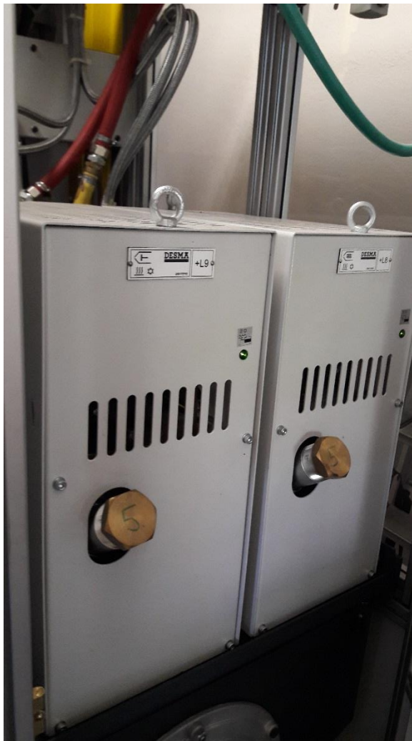
Slika 5.3: Temperirna sistema polža in brizgalnega cilindra
