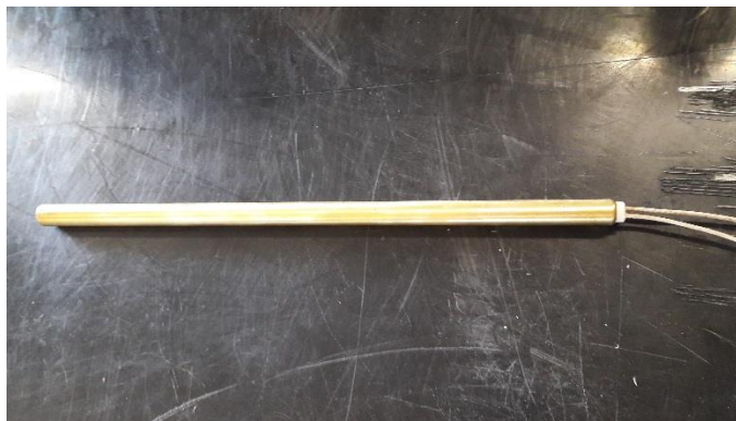
Slika 5.2: Električni grelec moči 800 W
