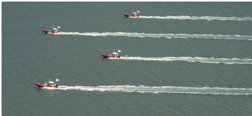
Slika 5.7: Avtonomna robotska plovila, ki služijo varovanju [57]
