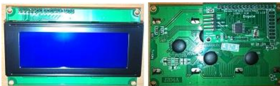
Slika 4.6: Sprednja in zadnja stran LCD prikazovalnika
