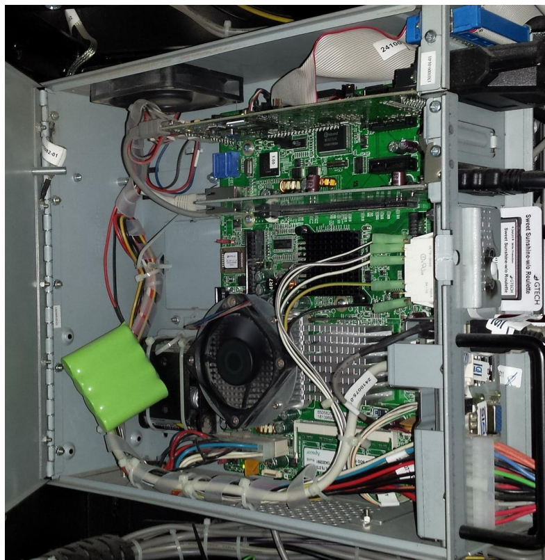
Slika 2.2: CPU plošča igralnega avtomata Atronic
