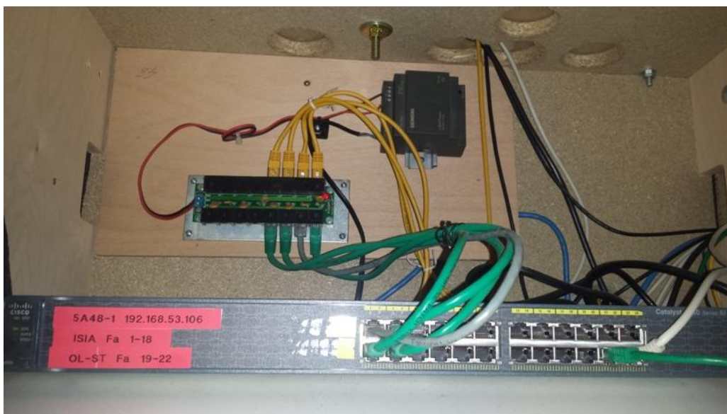
Slika 5.1: Stikalo Cisco 2960-24TC-S vgrajeno v podstavku igralnega avtomata
