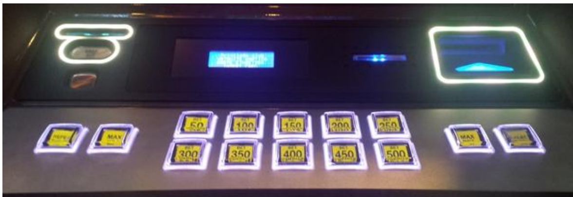
Slika 5.3: LCD prikazovalnik in čitalec kartic vgrajena v igralni avtomat
