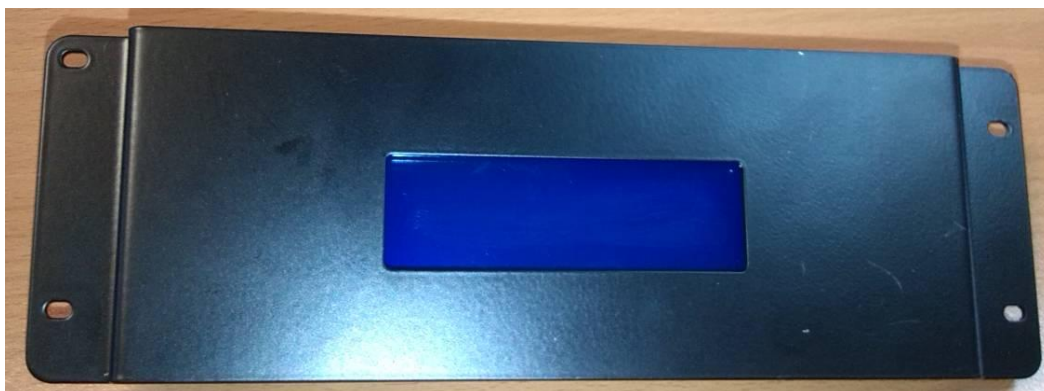
Slika 4.8: LCD prikazovalnik pritrjen na nosilec
