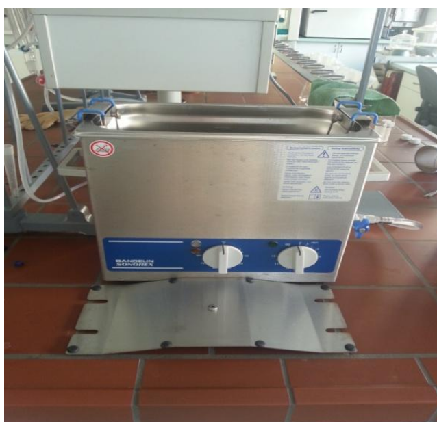
Slika 2-2: Ultrazvočna kopel, v kateri smo razplinjevali vzorce piv
