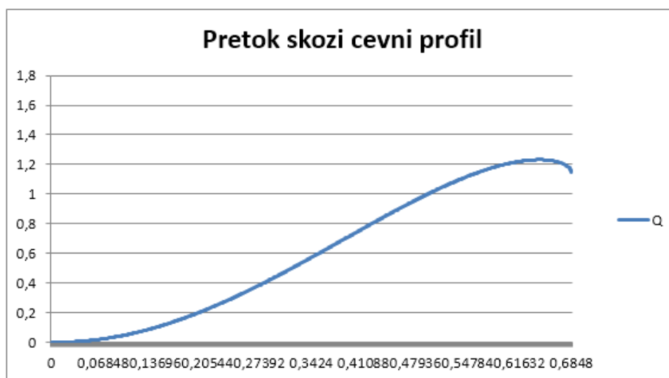
Slika 5.11: Prikaz pretoka pri maksimalnem hidravličnem padcu v odvisnosti od višine polnitve cevi
