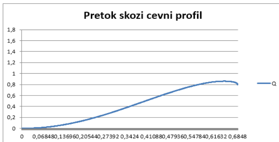
Slika 5.10: Prikaz pretoka pri minimalnem hidravličnem padcu v odvisnosti od višine polnitve cevi
