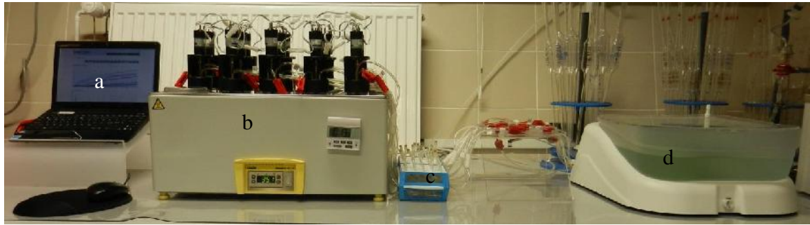
Slika 3.3: Sistem AMPTS II. (a) on-line beleženje koli ine nastalega bioplina, (b) termostatirana vodna kopel z reaktorji, (c) enota za odvzem vzorcev bioplina, (d) plovna celica za merjenje volumna nastalega bioplina.
