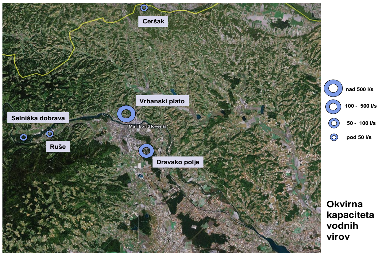
Slika 1: Črpališča Mariborskega vodovodnega sistema [11]
