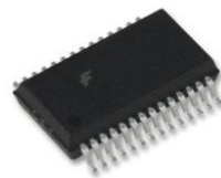
Slika 3.11: Mikrokrmilnik PIC18F23K20 v SSOP ohišju
