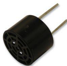
Slika 3.26: Ultrazvočni sprejemnik MA40S4R
