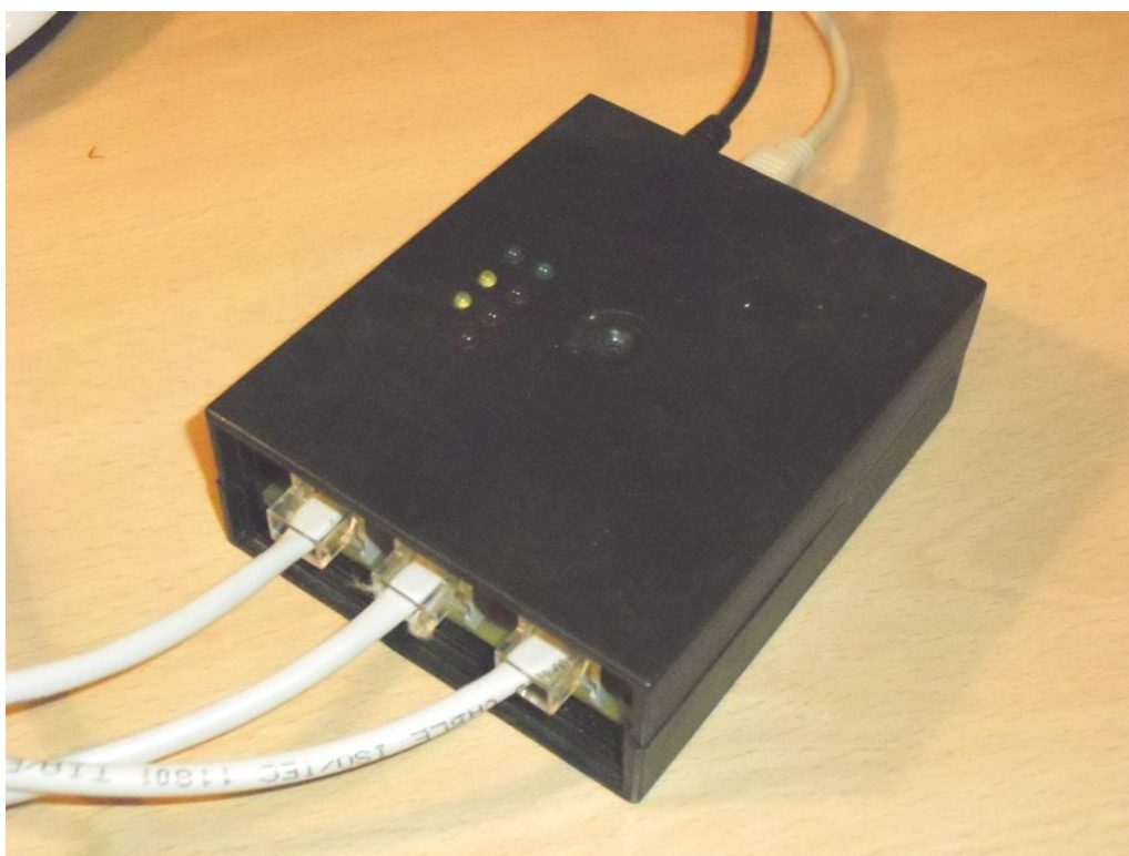
Slika 3.7: Sestavljen centralni vgrajen sistem vgrajen v plastično ohišje
