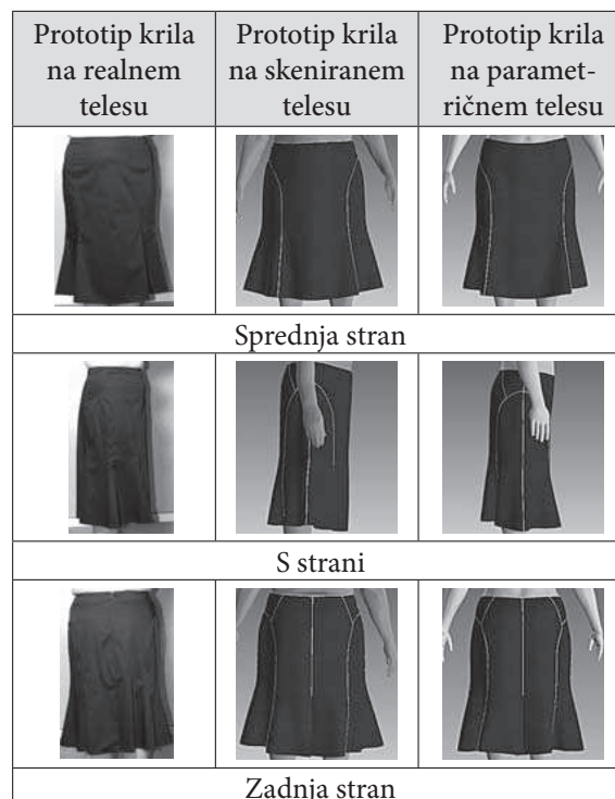
Slika 8: Prileganje prototipov kril NIKA-2Č pri realnem in virtualnem modelu na skeniranem in parametričnem telesu
