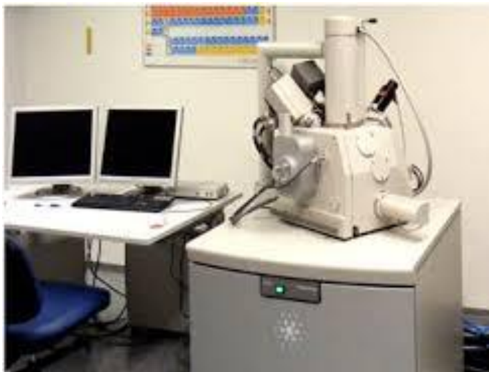
Slika 3.2: Vrstični elektronski mikroskop.
