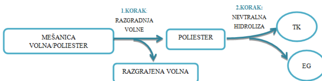
Slika 3.7: Shema ločitve mešanice volne in poliestra. [29]
