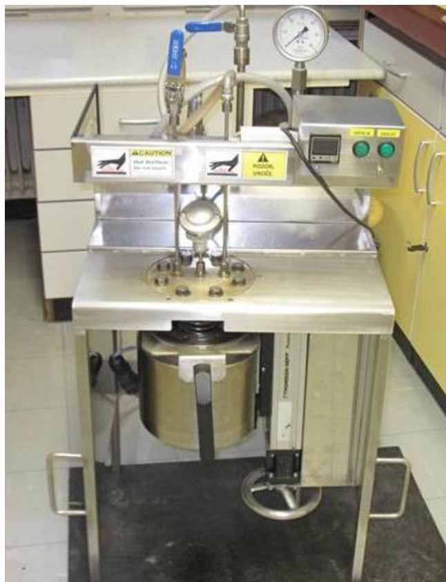
Slika 3.5: Končna izvedba visokotlačnega reaktorja za nevtralno hidrolizo PET.
