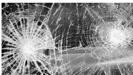
Slika 3-3: Poškodba lepljenega stekla ( http://www.mizarstvoperko.com/ )
