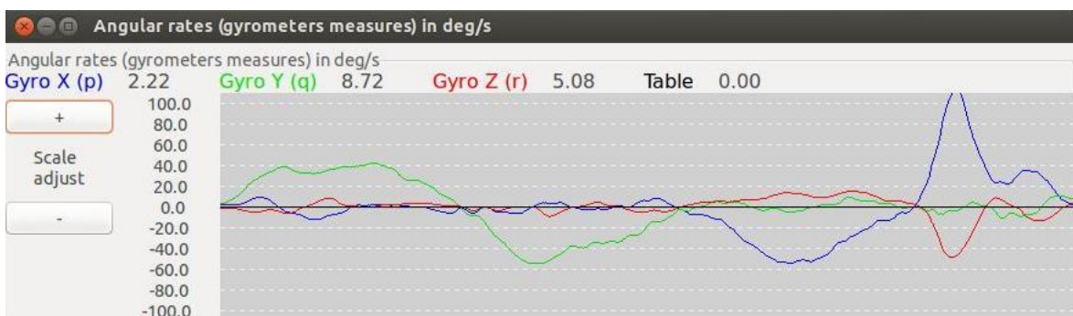
Slika 6.2: Testiranje 3-osnega žiroskopa kvadrokopterja AR.Drone (2)
