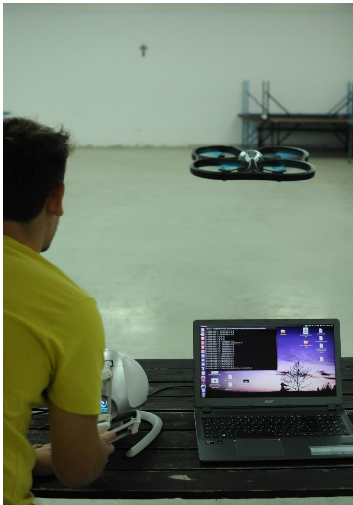
Slika 6.9: Vodenje kvadrokopterja AR.Drone s haptičnim vmesnikom Novint Falcon (2)
