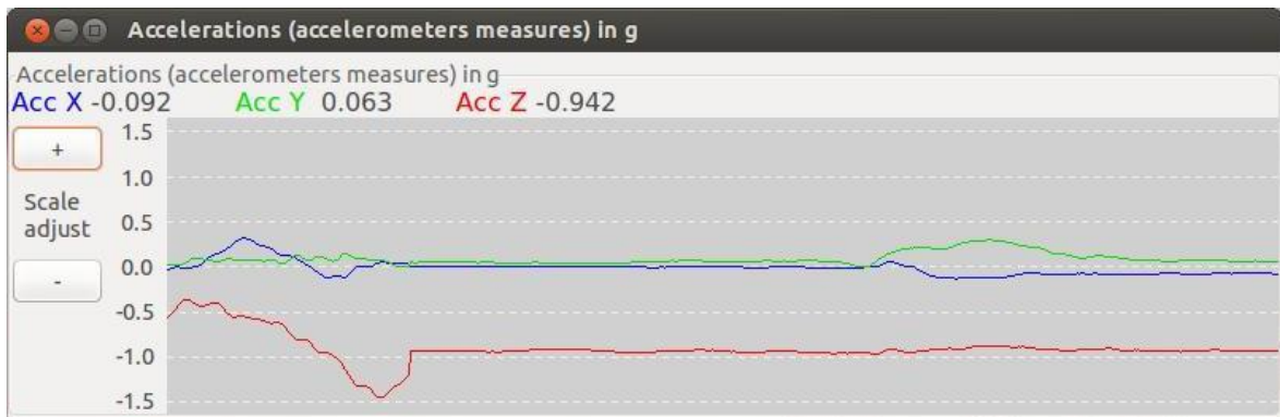
Slika 6.3: Testiranje 3-osnega pospeškometa kvadrokopterja AR.Drone
