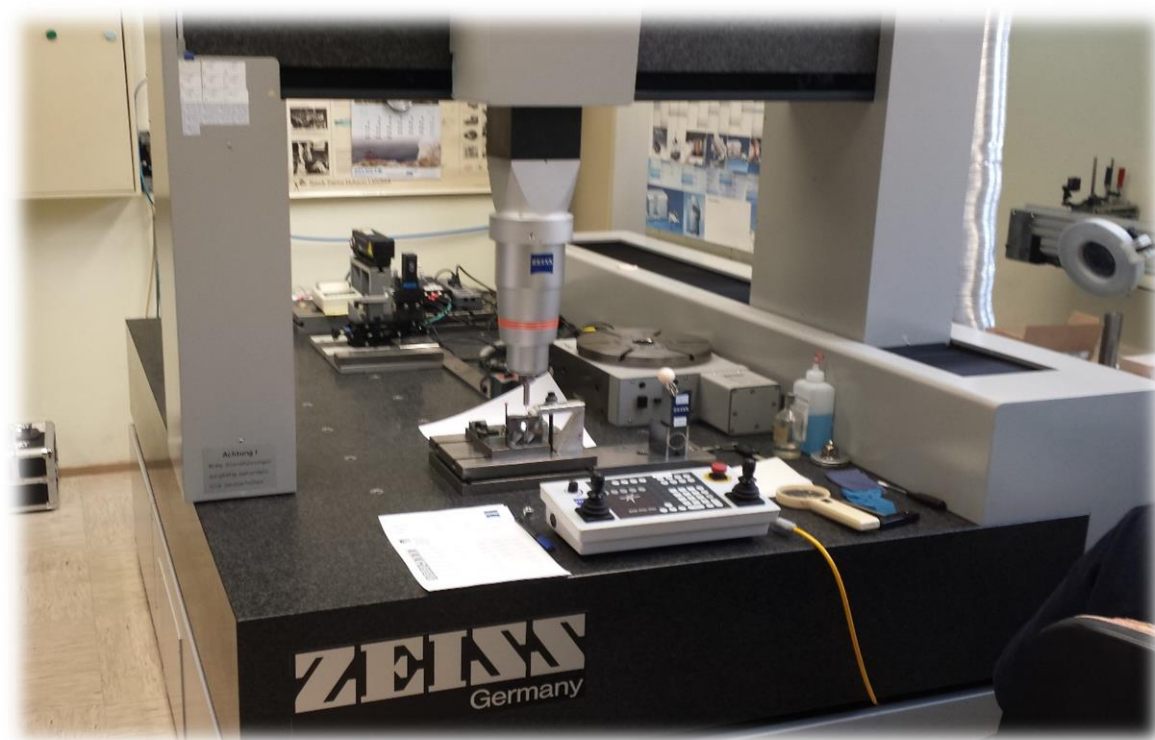
Slika 3-3: Merjenje notranjih premerov z merilno napravo ZEISS tipa UMC – 850.
