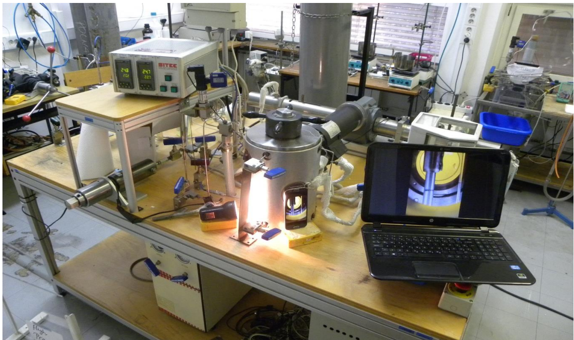
Slika 3-9: Naprava za merjenje površinske napetosti binarnih sistemov s kapilarno metodo.
