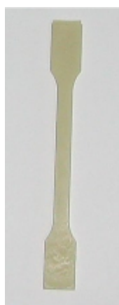
Slika 2.4-2: Vzorec za določanje odpornosti na razteg
