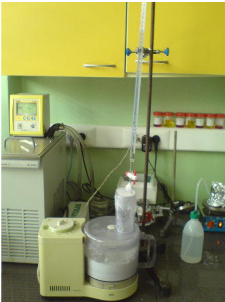
Slika 3.2-1: Mešanica škroba pripravljena v improviziranem kuhinjskem mešalniku – tekočino (glicerol + H 2 O) skozi bireto počasi dodajamo na trdno snov
