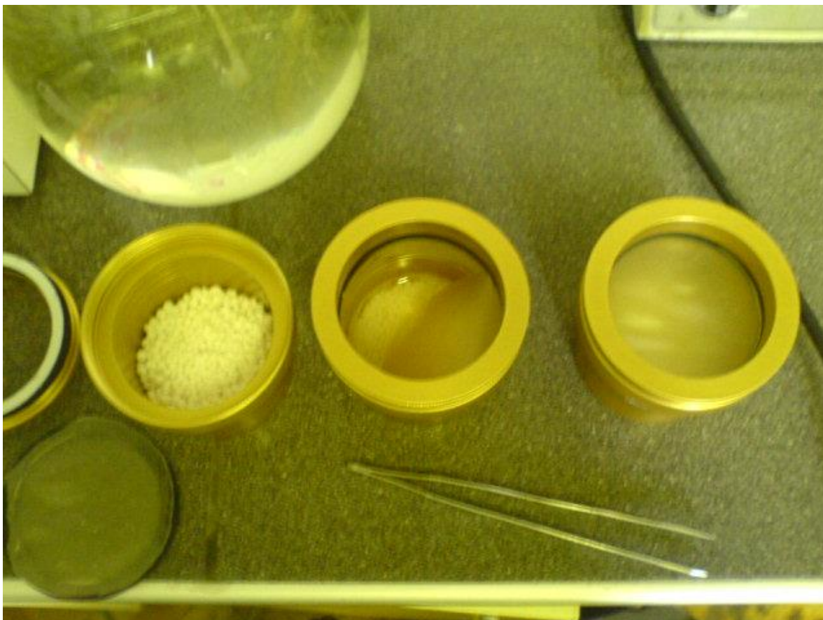
Slika 3.2-7: Merjenje prepustnosti vodne pare skozi vzorec
