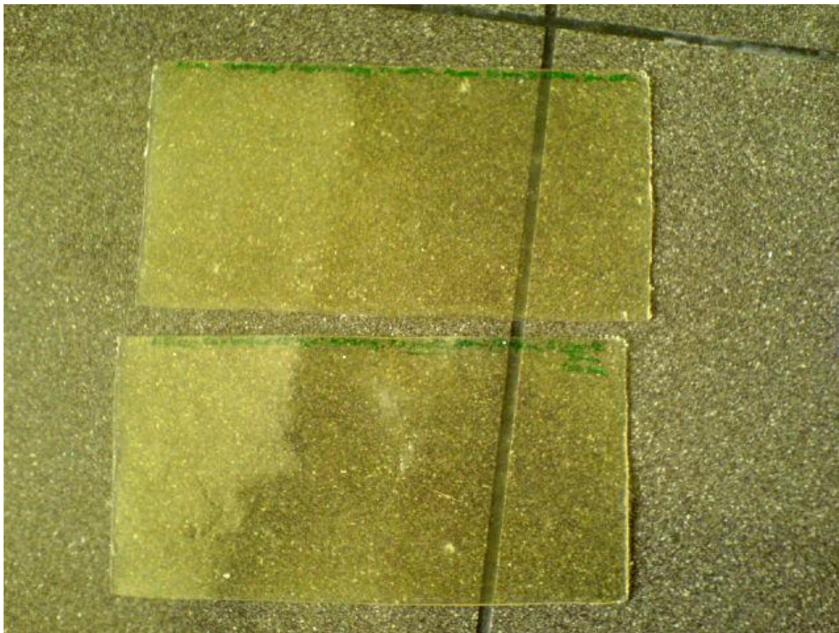
Slika 3.2-4: Končen material po obdelavi - gnetenju in stiskanju vzorca
