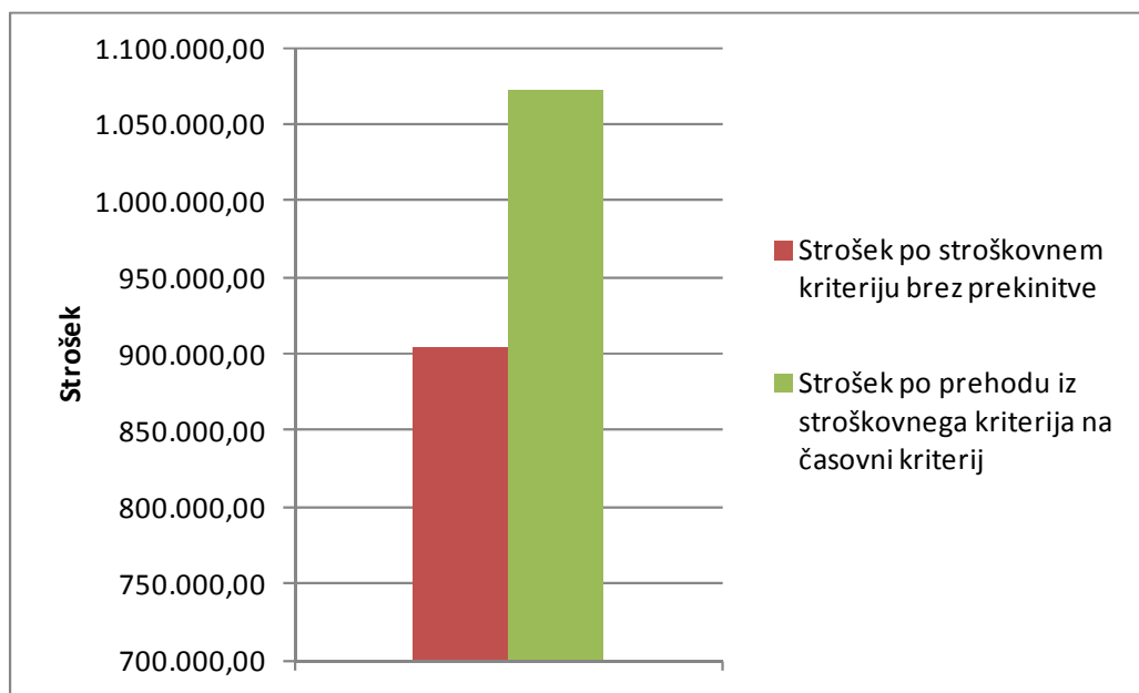
Slika 6.26: Razmerje stroškov med prvotnim proizvodnim scenarijem po stroškovnem optimizacijskem kriteriju, če bi ga pripeljali do konca in med novim proizvodnim scenarijem po časovnem optimizacijskem kriteriju zaradi pohitritve procesa v teku
