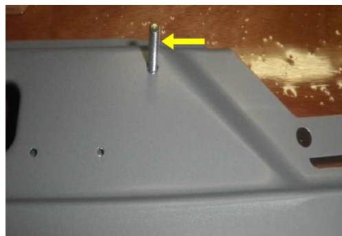
Slika 5.4: Nameščanje profila prečnega centralnega na šablono.
