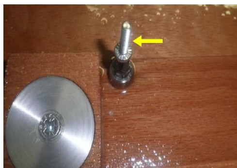
Slika 5.3: Namestitev vijaka ozemljitvenega na vijačni nastavek
