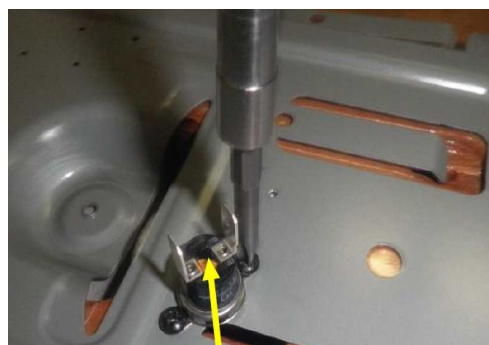
Slika 5.7: Namestitev in vijačenje termostata zaščitnega.
