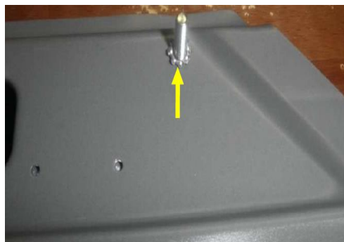
Slika 5.5: Namestitev podložke na vijak ozemljitveni.
