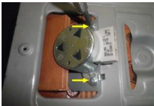
Slika 5.11: Namestitev ter vijačenje motorja ražnja
