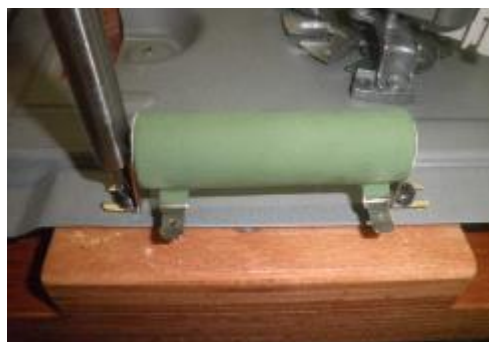
Slika 5.14: Namestitev ter vijačenje upora žičnega
