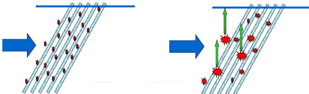
Slika 2.1 Združevanje majhnih oljnih kapljic v večje
