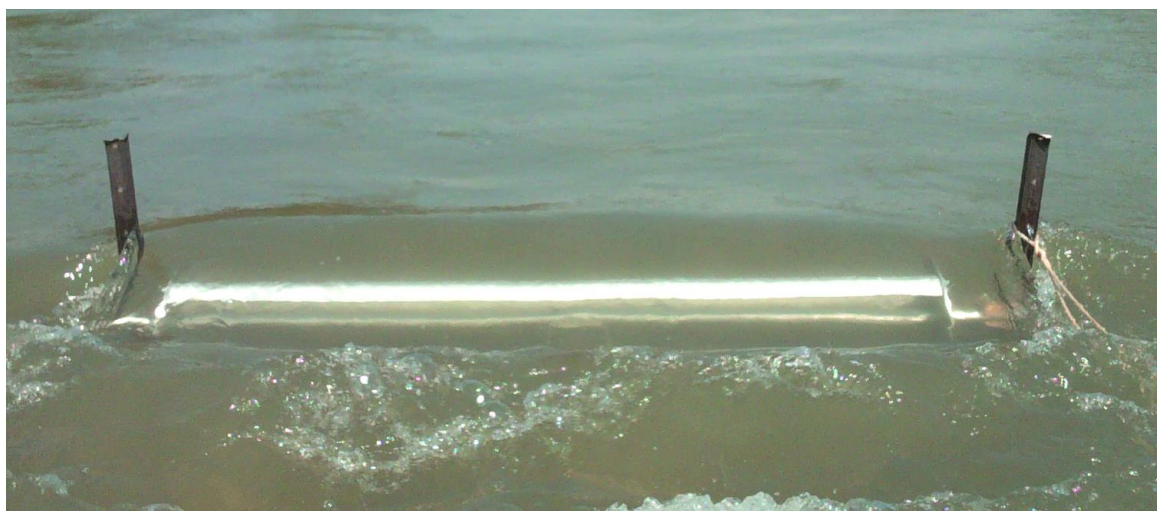
Slika 8.1: Preizkus modela turbine v naravnem vodotoku.
