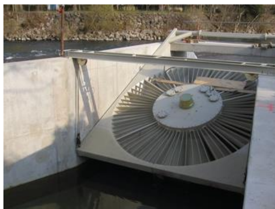
Slika 2.4: Shema postavitve (levo) in prototip VLH turbine v dvignjenem položaju podjetja MJ2 Technologies [14].
