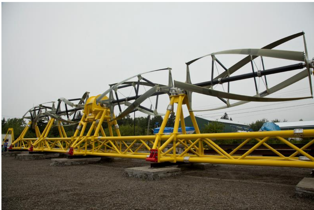
Slika 3.6: Rotorji izvedbe turbine Gorlov sestavljeni v nizu z enim generatorjem [25].
