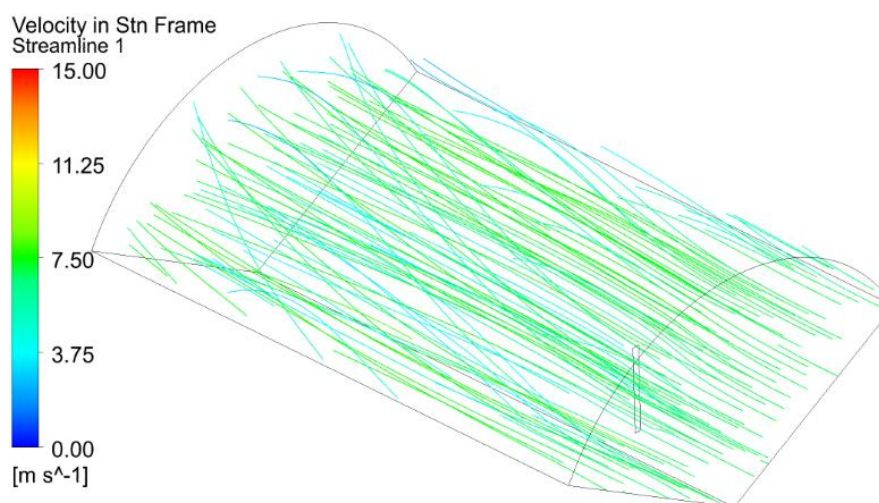
Slika 4.10: Razporeditev tokovnic v računskem območju pri absolutni hitrosti vetra 7 m/s in frekvenci 120 vrt/min
