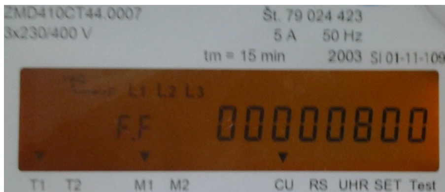
Slika 5.14: Programska napaka FF 00000800 na števcu električne energije [30]
