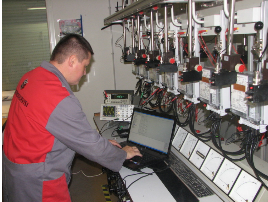
Slika 5.3: Preskušanje v neodvisnem laboratoriju za potrebe uvrščanja v nabor merilne opreme – meroslovni preskus [30]
