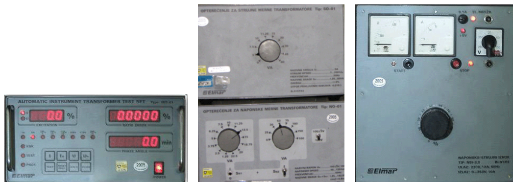
Slika 5.16: Sistem za kontrolo točnosti merilnih transformatorjev [30]
