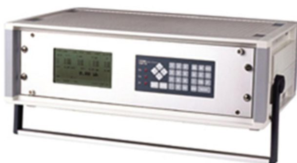
Slika 5.7: Referenčni etalon TEMP 100 in programsko orodje C.A.T.S. [16]
