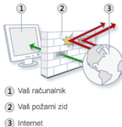
Slika 3: Delovanje požarnega zidu
