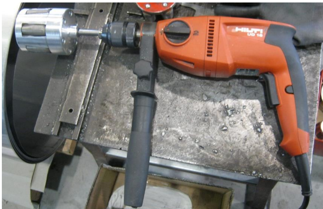
Slika 3.34: Vrtalnik Hilti UD 16 z orodjem za razširjanje tankostenskih cevi
