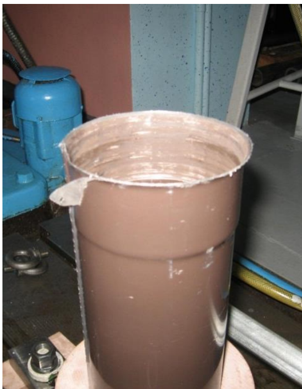
Slika 3.16: Rezultat preglobokega potiska orodja v cev
