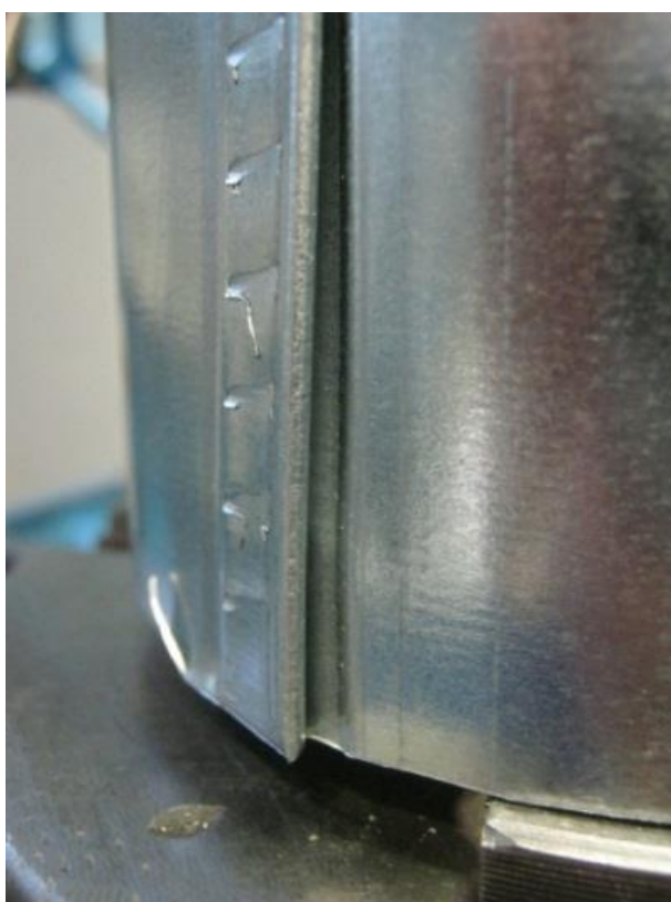
Slika 3.10: a) Začetni znaki odpiranja spoja b) Odprt spoj
