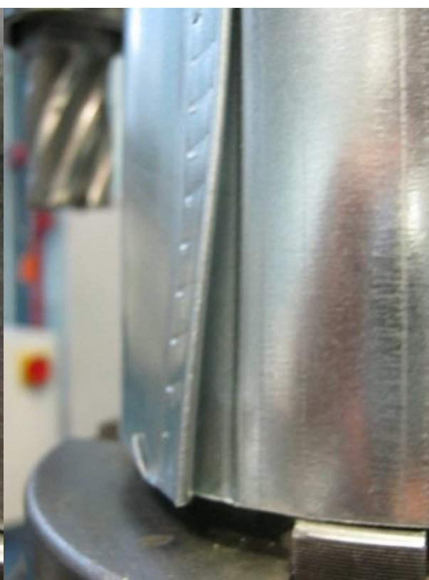
Slika 3.10: a) Začetni znaki odpiranja spoja b) Odprt spoj
