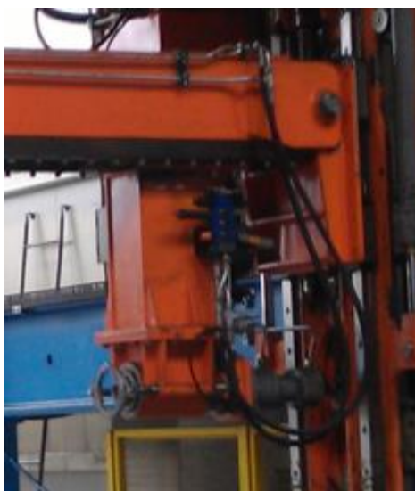
Slika 2.3: Prijemalo 2 s hidravličnim motorjem
